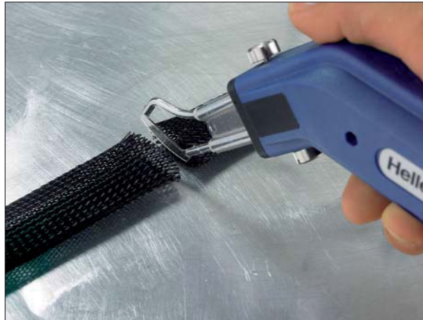
Das Ausfransen beim Schneiden eines Geflechtschlauchs lässt sich mit dem HSG0 vermeiden.
