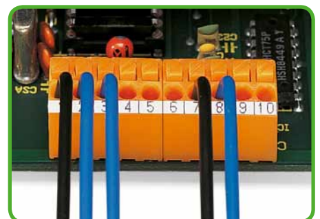
Aneinanderreihen von Klemmenblöcken ohne Polteilungsverlust.
