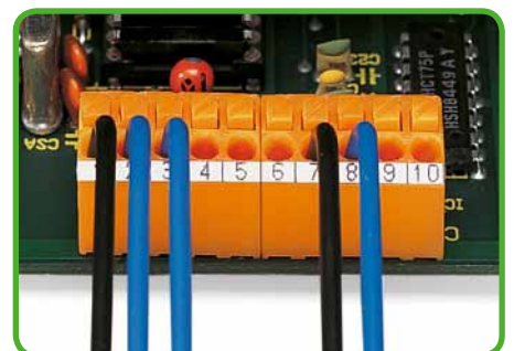
Aneinanderreihen von Klemmenblöcken ohne Polteilungsverlust.
