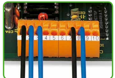
Aneinanderreihen von Klemmenblöcken ohne Polteilungsverlust.
