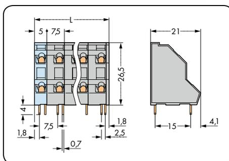
$L = (\text{Polzahl} - 1) \times \text{Rastermaß} + 5 \text{ mm} + 1 \text{ mm}$
