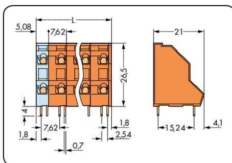
$L = (\text{Polzahl} - 1) \times \text{Rastermaß} + 5,08 \text{ mm} + 1 \text{ mm}$
