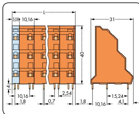
$L = (\text{Polzahl} - 1) \times \text{Rastermaß} + 5,08 \text{ mm} + 1 \text{ mm}$
