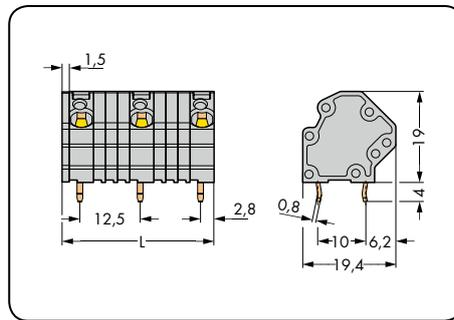
$L = (\text{Polzahl} - 1) \times \text{Rastermaß} + 5 \text{ mm} + 1,5 \text{ mm}$
