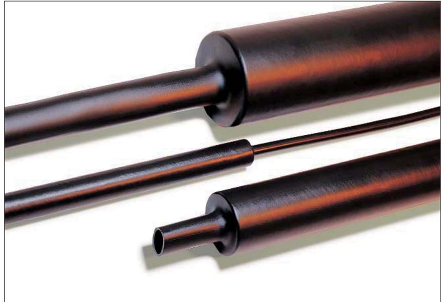
Mittelwandiger Schrumpfschlauch TREDUX MA47 mit Innenkleber und Schrumpfrate 4:1.
