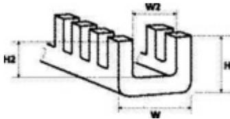
Optimaler Schutz von Kabeln und Leitungen an Blechkanten.
