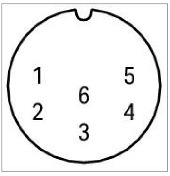
Anschließbare Leitung Ø 2,0 ... 10,5 mm / max. 2,5 mm²
