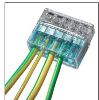
Beliebige Querschnitte von 0,5 bis 2,5 mm 2 können problemlos in einer Klemme gesteckt werden.
