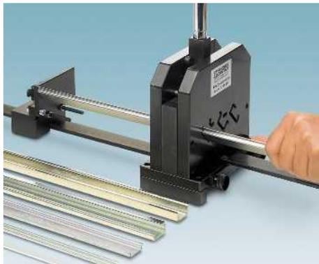
Für die schnelle span- und gratlose Bearbeitung von Tragschienen und Kabelkanälen stehen Profilschneider zur Verfügung. Eine optional aufsetzbare Hydraulikeinheit automatisiert den manuellen Tragschienschnneider.
