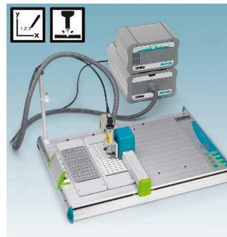
Der CMS-P1-PLOTTER kann neben Streifen- und UniCard-Material auch Bogenware beschriften. Sein integriertes Stiftd Depot erleichtert das Handling und hilft, das Eintrocknen der Schreibstifte zu verhindern. Durch einfaches und schnelles Austauschen des Plottkopfes mit dem Gravuraufsatz wird aus dem CMS-P1-PLOTTER eine Gravureinheit.
