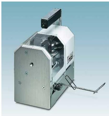
Der Abisolier- und Crimpautomat CF 3000-2,5 verarbeitet Aderendhülsen in Bandwarenausführung mit Isolierkragen nach DIN 46228-4. Das Gerät kann Leiter im Querschnittsbereich von 0,25 - 2,5 mm<sup>2</sup> in einem Arbeitsgang abisolieren und mit Aderendhülsen versehen. Die Umrüstung des Automaten auf unterschiedliche Querschnitte ist innerhalb einer Minute möglich.
