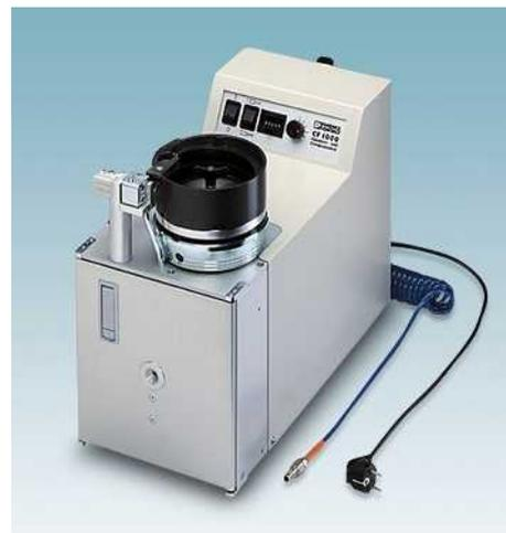
Der Abisolier- und Crimpautomat CF 1000 verarbeitet lose (Schüttware) Aderendhülsen mit Isolierkragen nach DIN 46228-4. Mit diesem Automat können Leiter in einem Arbeitsgang abisoliert und mit Aderendhülsen versehen werden.
