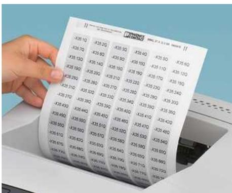
Für kleine Druckmengen können Etiketten auch mit handelsüblichen Desktop-Laserdruckern beschriftet werden. Um die Entnahme einzelner Schilder zu erleichtern, sind die Kopierbögen mit Gitterabzug versehen.
