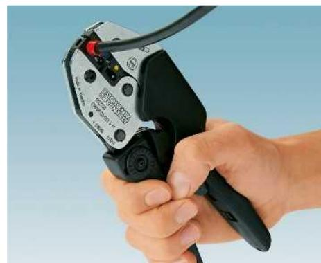
Das umfangreiche Programm professioneller Crimpzangen ermöglicht die Verarbeitung von verschiedenen Kontaktarten bis 120 mm<sup>2</sup>. Eine innovative Konstruktion und ergonomisch geformten Griffe reduzieren die erforderlichen Kräfte um bis zu 25 Prozent.
