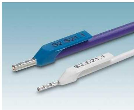
Die Aderendhülsen sind mit einem beschriftbaren Isolierkragen ausgestattet und werden vor dem Vercrimpen beschriftet. Durch diese Kombination wird ein Arbeitsgang eingespart.
