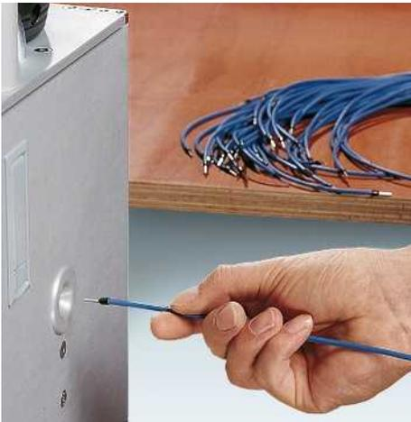
Der Abisolier- und Crimpautomat verarbeitet lose Aderendhülsen von 0,25 bis 4 mm<sup>2</sup> mit Isolierkragen nach DIN 46228-4. Durch eine optimierte Sensortechnik lassen sich kleine Querschnitte jetzt noch besser verarbeiten.
