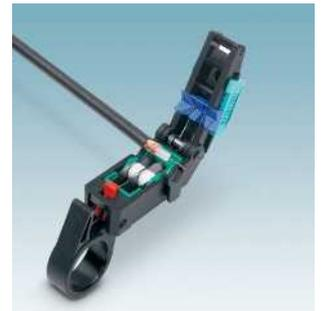
Entmantelung für Koaxialkabel
