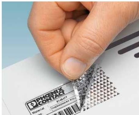
Manipulationssichere Etiketten werden als Typenschilder oder Siegelmarkierungen eingesetzt. Beim Ablösen trennt sich ein Teil der metallisierten Schicht ab und hinterlässt ein Muster an Etikett und Untergrund.
