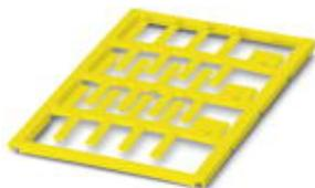
Kabelmarker, Matte, gelb, unbeschriftet, beschriftbar mit: BLUEMARK CLED, BLUEMARK LED, Plotter, Montageart: Einschieben, Kabeldurchmesser: 0,6-22 mm, Schriftfeldgröße: 18 x 4 mm
