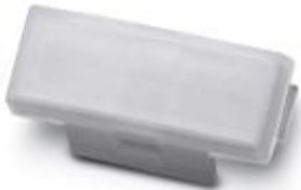
Kunststoffkabelmarker, transparent, unbeschriftet, Montageart: Kabelbindermontage, Kabeldurchmesser: \geq 6 mm, Schriftfeldgröße: 29 x 8 mm
