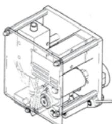
Vollpneumatisch, zur Auftragung von Klebebandabschnitten, ein- oder doppelseitig, zum Kennzeichnen, Verschließen, Sichern und Befestigen. Durch seine kompakte Bauform besonders zur Integration in Produktionsanlagen geeignet.
