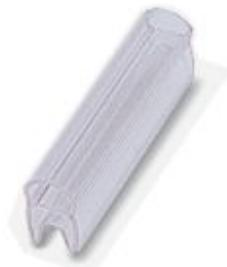
Ader-Bezeichnungsträger, transparent, unbeschriftet, Montageart: Aufschieben, Kabeldurchmesser: 4-7 mm, Schriftfeldgröße: 4 x 30 mm
