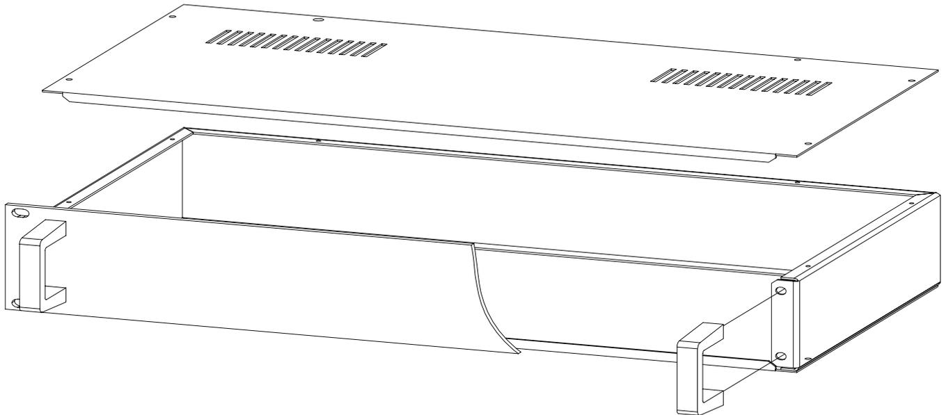
Die Einzelteile des Einschubs sind schwarz pulverbeschichtet. Das Deckblech ist mit Lüftungsschlitzen versehen.
