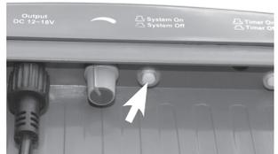
9. Die Betriebsspannung der Pumpe kann über einen Regler zwischen 12 V und 18 V eingestellt werden. Somit ist die Leistung der Pumpe regelbar.
