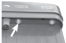
2. **Stellung OFF (Aus):** Der Ausgang ist ausgeschaltet. Der Akku wird über das Solarmodul aufgeladen und die elektrische Energie wird gespeichert.
