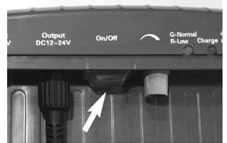
2. **Stellung 0 (OFF) (Aus):** Die Pumpe ist ausgeschaltet. Der Akku wird über das Solarmodul aufgeladen und die elektrische Energie wird gespeichert. Die gelbe LED leuchtet sobald der Akku über das Solarmodul geladen wird.
