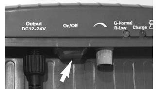
7. Die Betriebsspannung der Pumpe kann über einen Regler zwischen 12 V und 24 V eingestellt werden. Somit ist die Leistung der Pumpe regelbar.
