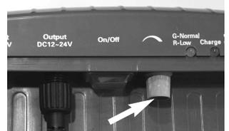
**Hinweis:** Die Stecker und Buchsen sind verpolungsgeschützt, es darf beim Einstecken keine Gewalt angewendet werden. Das Glas des Solarmoduls ist bruchempfindlich.
