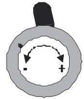
Durch Drehen am Drehknopf des Glas-Heizstabes verändern Sie den Schalterpunkt des Bi-Metall Reglers und damit die Soll-Temperatur der Ätzflüssigkeit. Ein Drehen in Plusrichtung erhöht die Schaltwelle des Reglers und damit die Bad-Temperatur, das Drehen in Minusrichtung reduziert die Schaltschwelle des Reglers.
