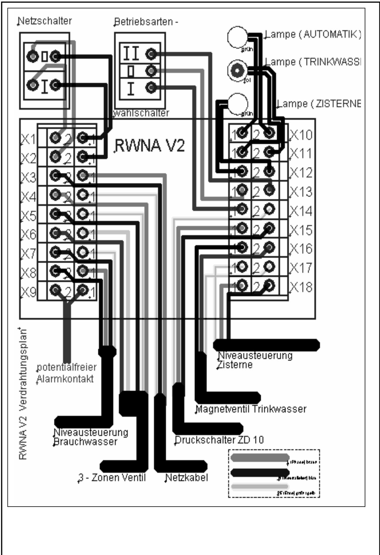
**Anhang VII: Einbaubeispiel Regenwasser- Kompaktanlage mit elektronischer Niveauekontrolle**
