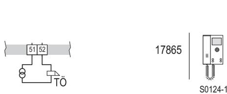
Schaltplan: Schalten z.B. eines Etagentüröffners mit der Sondertaste, oder Auslösen der Türöffnerautomatik über den Etagedrucker.
