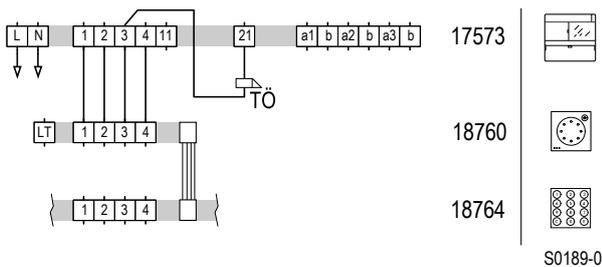
Schaltplan: Anschluss Codiermodul über Systembus.
