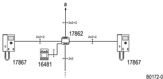
*Blockschaltbild: UP Videoverteiler in einer Hauptbuslinie.*
