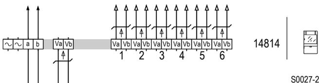
Schaltplan: Anschluss eines Linienschalters.
