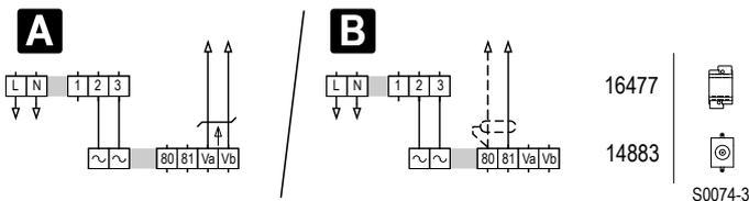
**A** Anschluss an TwinBus Videoleitung und Speisung aus Netztrafo 16477.
