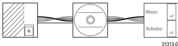
**i Hinweis:** Eine Kennzeichnung (rot-grün) ist am Modul nicht vorhanden. Beide Kreuzverbinder müssen daher am Kameramodul gemäß Abbildung "Beispielhaftes Verbinden von Altmodulen 147... mit Modulen 187..." korrekt aufgesteckt werden.
