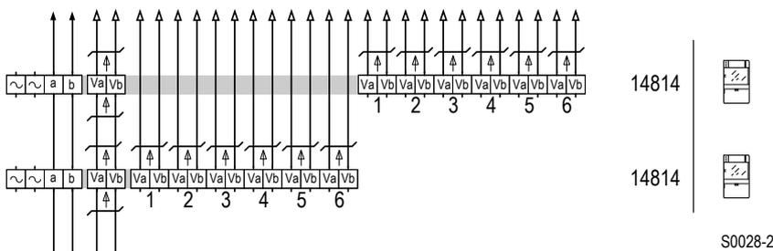
Schaltplan: Kaskadierung mit 2 Linienschaltern.
