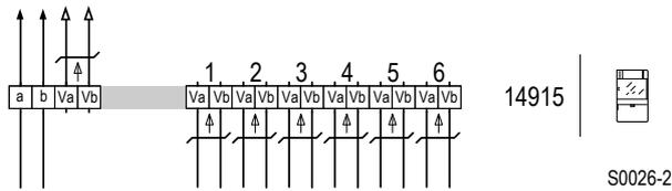
Schaltplan: Anschluss von bis zu 6 Kameras, Spannungsversorgung über Systembus.
