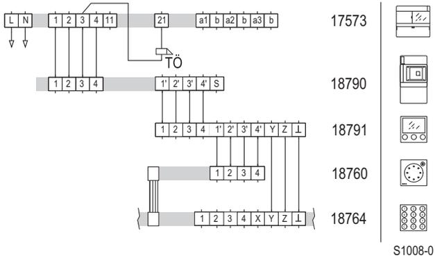
Schaltplan: Anschluss unter Verwendung des Programmieradapters. Der Anschluss eines Codiermoduls zur numerischen Anwahl eines Teilnehmers ist optional.
