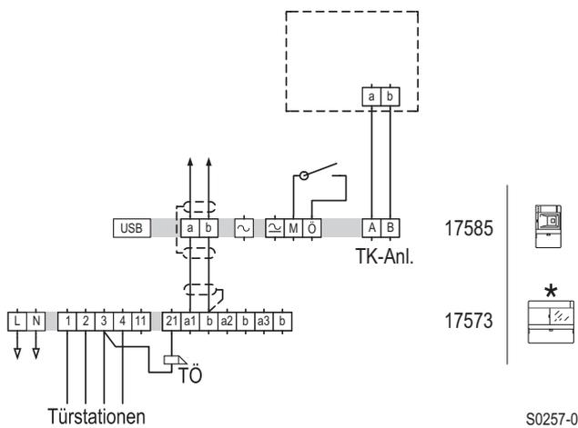
\* Bitte beachten Sie die Verbindung des Systembussteckers – siehe "Systembusstecker zwischen Netzgerät und TK Adapter".
