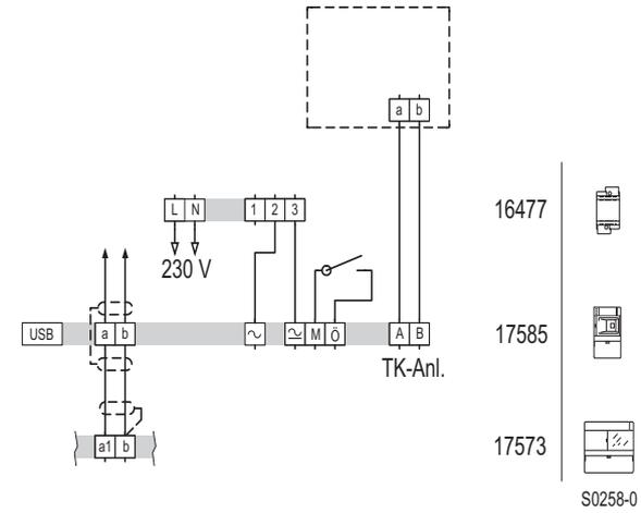
Schaltplan: Anschluss mit Versorgung aus Netztrafo 16477 12 V AC
