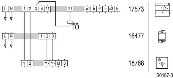
Schaltplan: Anschluss des Zugangsmoduls als Einzelgerät.
