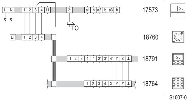
Schaltplan: Anschluss ohne Programmieradapter. Der Anschluss eines Codiermoduls zur direkten numerischen Anwahl eines Teilnehmers ist optional.
