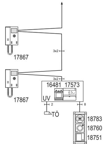
Blockschaltbild: Videosystem mit zentraler Spannungsversorgung.
