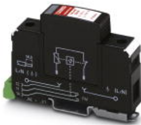
Überspannungsableiter bestehend aus Basiselement mit FM-Kontakt und Schutzstecker mit Hochleistungsvaristor, zur Montage auf NS 35/7,5, 1-kanalig
