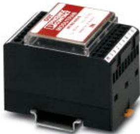
Tragschienenmodul mit Überspannungsgrob- und feinschutz für RS-485-Schnittstelle, zur Montage auf NS 35/7,5, Gehäusebreite: 50 mm
