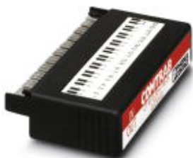
LSA-PLUS-Stecker (COMTRAB CT 10) mit Überspannungsgrob-/feinschutz für 18 Signalleitungen - GND und Grobschutz GND - PE. Nennspannung: 24 V DC/AC. Ausführung: 10 Doppeladern
