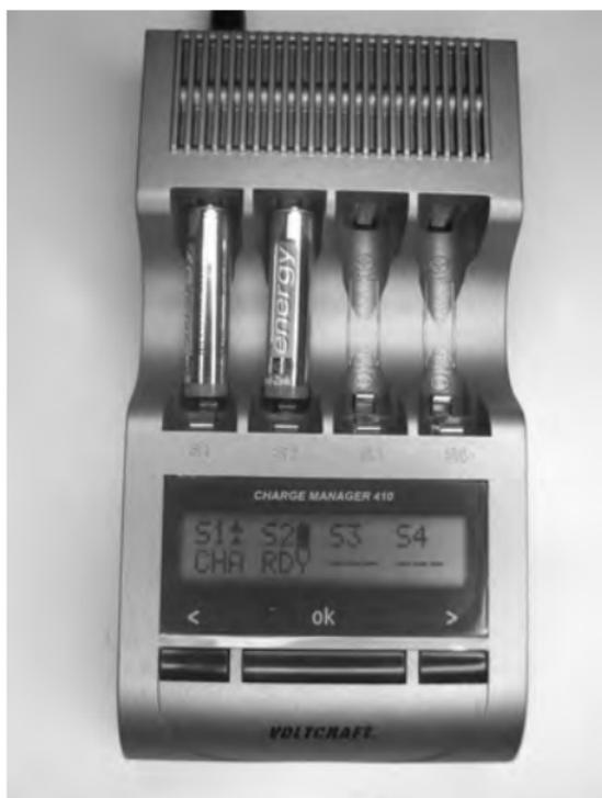
**Abb. 035:** Profi-Ladegerät Nickel-Zink, für AA und AAA-Zellen
