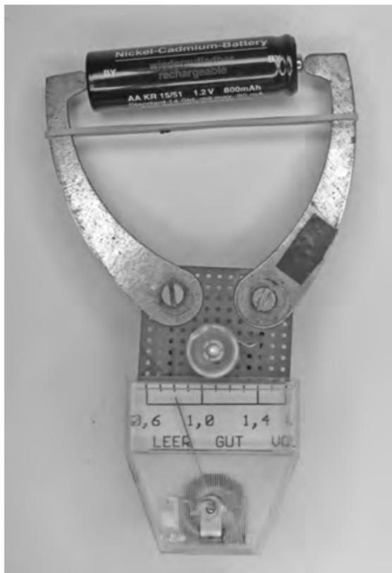
**Abb. 044:** Einfacher Akkuprüfer (Selbstbauteurgerät) für AA- und AAA-Akkuzellen mit Drehspulinstrument und Glühbirne (1,5 V) als Belastungswiderstand
