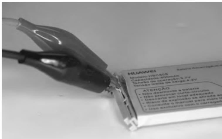
**Abb. 039:** Klemmverbindung mit den Akkukontakten
