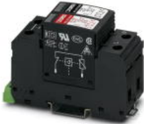
Überspannungsableiter für 3-Leiter-Stromversorgungssysteme (L1, N, PE), bestehend aus Basiselement mit FM-Kontakt und Schutzsteckern, zur Montage auf NS 35.
