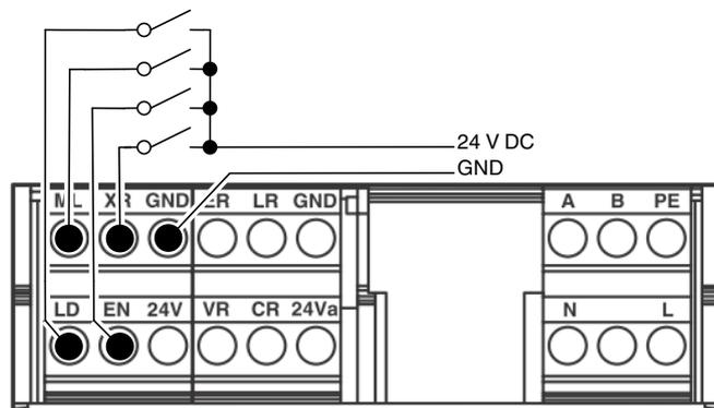
Bild 5-7 Eingänge an Schaltern mit externer Versorgung
