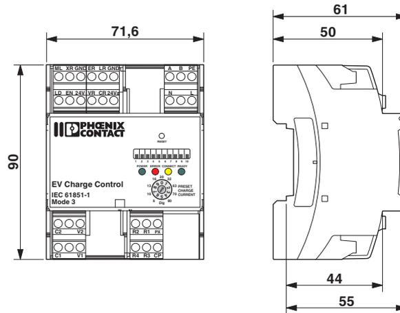
Bild 3-1 Abmessungen
