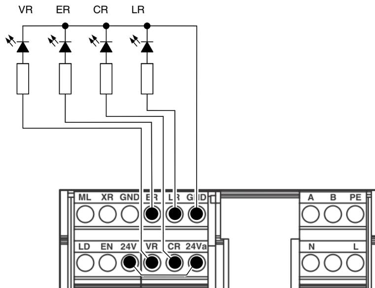
Bild 5-3 Ausgangsbeschaltung mit LEDs
