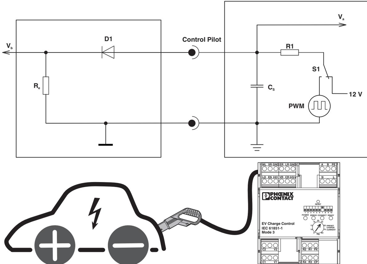
Bild 4-6 Beschriftung Simplified Control Pilot
