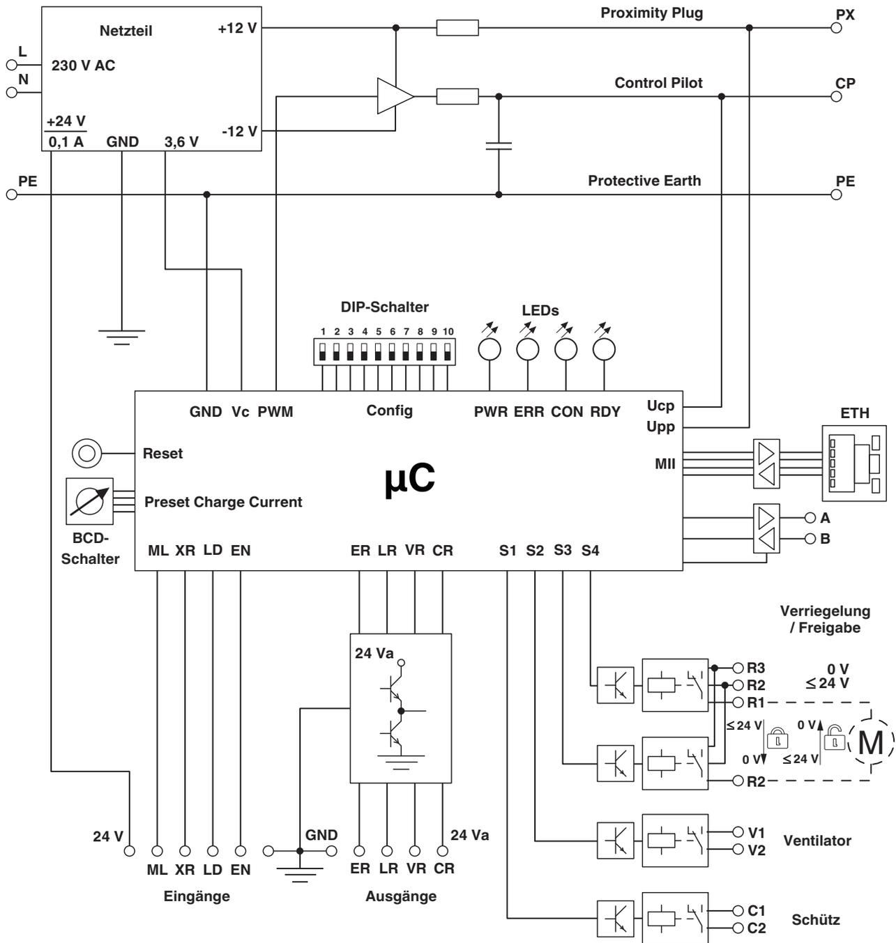
Bild 2-2 Prinzipaufbau
