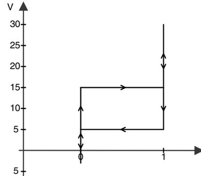
Bild 5-4 Zuordnung der logischen Zustände zu den Spannungen
