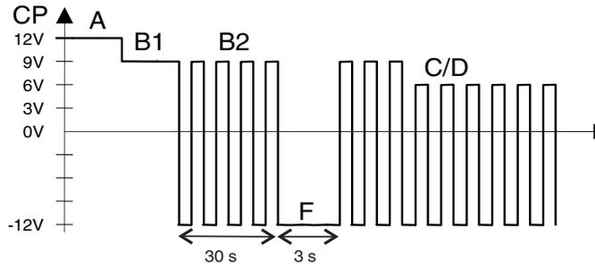
Bild 4-7 CP-Signalverlauf Wake-Up-Sequenz
