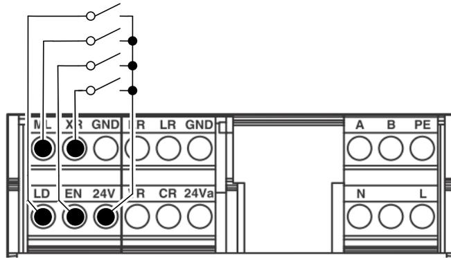
Bild 5-6 Eingänge an Schaltern mit interner Versorgung
