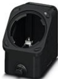
HEAVYCON EVO-Tüllegehäuse aus Kunststoff, mit Bajonettflansch für die EVO-Verschraubung, B10, für Längsbügel, Höhe 60,5 mm, ohne EVO-Verschraubung
