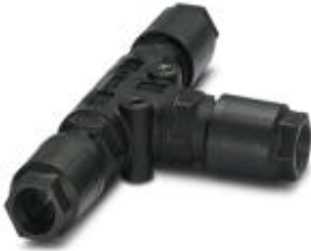
QUICKON T-Verteiler, schwarz, 4+PE-polig, 1,0 mm 2 ... 2,5 mm 2 / 690 V / 20 A, für Kabeldurchmesser 6 mm ... 11 mm, mit drei Quickon-Muttern
