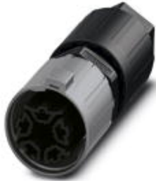
QUICKON-Steckverbinder, schwarz, 4+PE-polig, 1,0 mm 2 ... 2,5 mm 2 / 690 V / 20 A, mit QUICKON-Mutter, für Leitungen mit Durchmesser 6 mm ... 11 mm.
