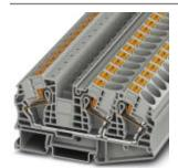
Durchgangsklemme, Anschlussart: Push-in-Anschluss, Querschnitt: 0,5 mm² - 25 mm², AWG: 20 - 4, Breite: 12,2 mm, Farbe: grau, Montageart: NS 35/7,5, NS 35/15
