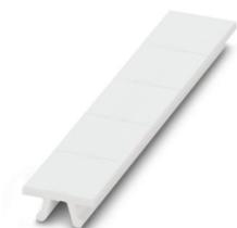
Zackband, Streifen, weiß, unbeschriftet, beschriftbar mit: PLOTMARK, CMS-P1-PLOTTER, Montageart: verrasten, für Klemmenbreite: 12,2 mm, Schriftfeldgröße: 12 x 10,5 mm, Anzahl der Einzelschilder: 5
