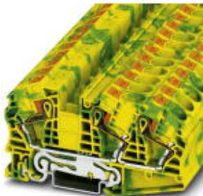
Schutzleiter-Reihenklemme, Anschlussart: Push-in-Anschluss, Querschnitt: 0,5 mm<sup>2</sup> - 25 mm<sup>2</sup>, AWG: 20 - 4, Breite: 12,2 mm, Farbe: grün-gelb, Montageart: NS 35/7,5, NS 35/15
