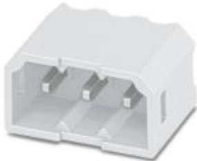
Grundgehäuse, Nennstrom: 6 A, Bemessungsspannung (III/2): 250 V, Polzahl: 4, Rastermaß: 2,5 mm, Farbe: weiß, Kontaktoberfläche: Zinn, Montage: Gurtverpackte SMD/THT/THR -Bauelemente
