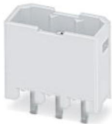
Grundgehäuse, Nennstrom: 6 A, Bemessungsspannung (III/2): 250 V, Polzahl: 2, Rastermaß: 2,5 mm, Farbe: weiß, Kontaktoberfläche: Zinn, Montage: SMD/THT/THR
