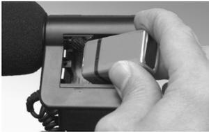
Abb. 3 – Batterie einsetzen
