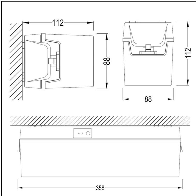
Kompakte, universell einsetzbare LED-Sicherheits- und Rettungszeichenleuchte IP 54, als Einzelbatterie-Notleuchte mit AUTOTEST-Funktion, Signalisierung über 2x LED, inklusive Prüftaster, gemäß DIN EN 60598-1, DIN EN 60598-2-22 und DIN EN 1838 für Anlagen gemäß DIN VDE 0108 / 10.89 zum separaten Betrieb.
