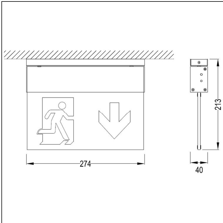
Exklusive LED-Scheibenleuchte in modernem Design, als Einzelbatterie-Scheiben-Notleuchte mit AUTOTEST-Funktion, Signalisierung über 1x mehrfarbige LED, inklusive Prüftaster, gemäß DIN EN 60598-1, DIN EN 60598-2-22 und DIN EN 1838 für Anlagen gemäß DIN VDE 0108 / 10.89 zum separaten Betrieb.
