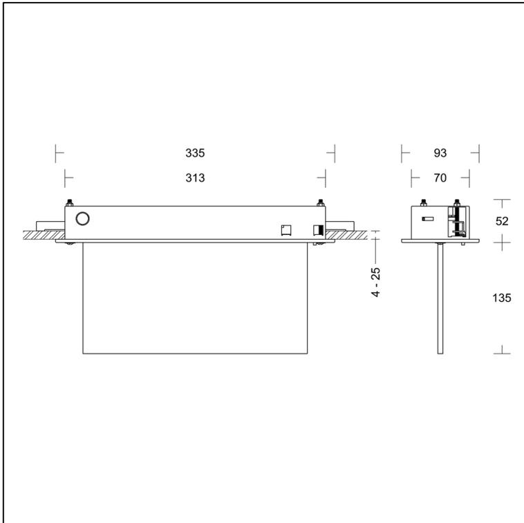
Exklusive LED-Scheibenleuchte in modernem Design, als Einzelbatterie-Scheiben-Notleuchte mit AUTOTEST-Funktion, Signalisierung über 1x mehrfarbige LED, inklusive Prüftaster, gemäß DIN EN 60598-1, DIN EN 60598-2-22, DIN EN 62034 und DIN EN 1838 für Anlagen gemäß DIN VDE 0108, zum separatem Betrieb.
