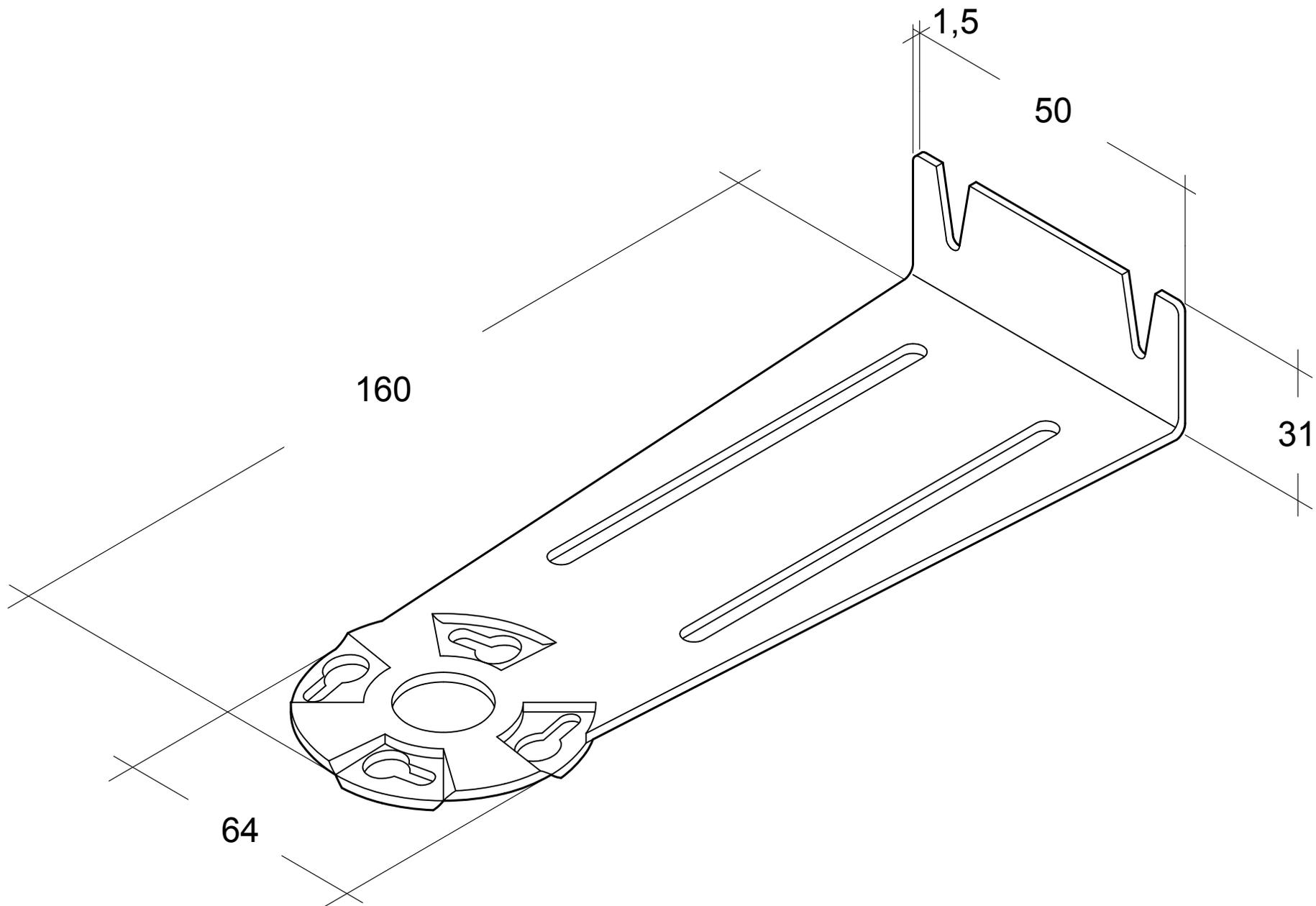
Konsole für Rohrradial-Ventilator 100-125 (2 St.)
