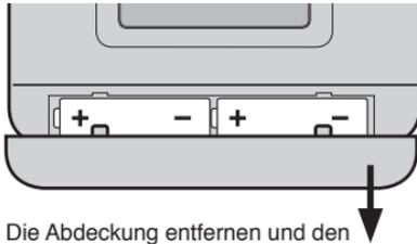
Die Abdeckung entfernen und den Plastikstreifen im Inneren entsorgen, um die Batterien zu aktivieren.
