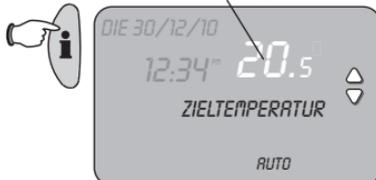
Im Auto-Modus hält der Thermostat die eingestellte Temperatur, bis der nächste Programm-Zeitintervall beginnt. Er kehrt dann zu dem Wert zurück, der für diesen Intervall eingestellt wurde. Schalten Sie in den manuellen Modus um, um über längere Zeiträume eine konstante Temperatur beizubehalten (siehe Seite 9).
