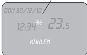
Der Thermostat ist so voreingestellt, dass er nur das Heizungssystem steuert. Wenn er richtig installiert und eingestellt wurde, kann er auch dazu verwendet werden, die Kühlung zu steuern.
