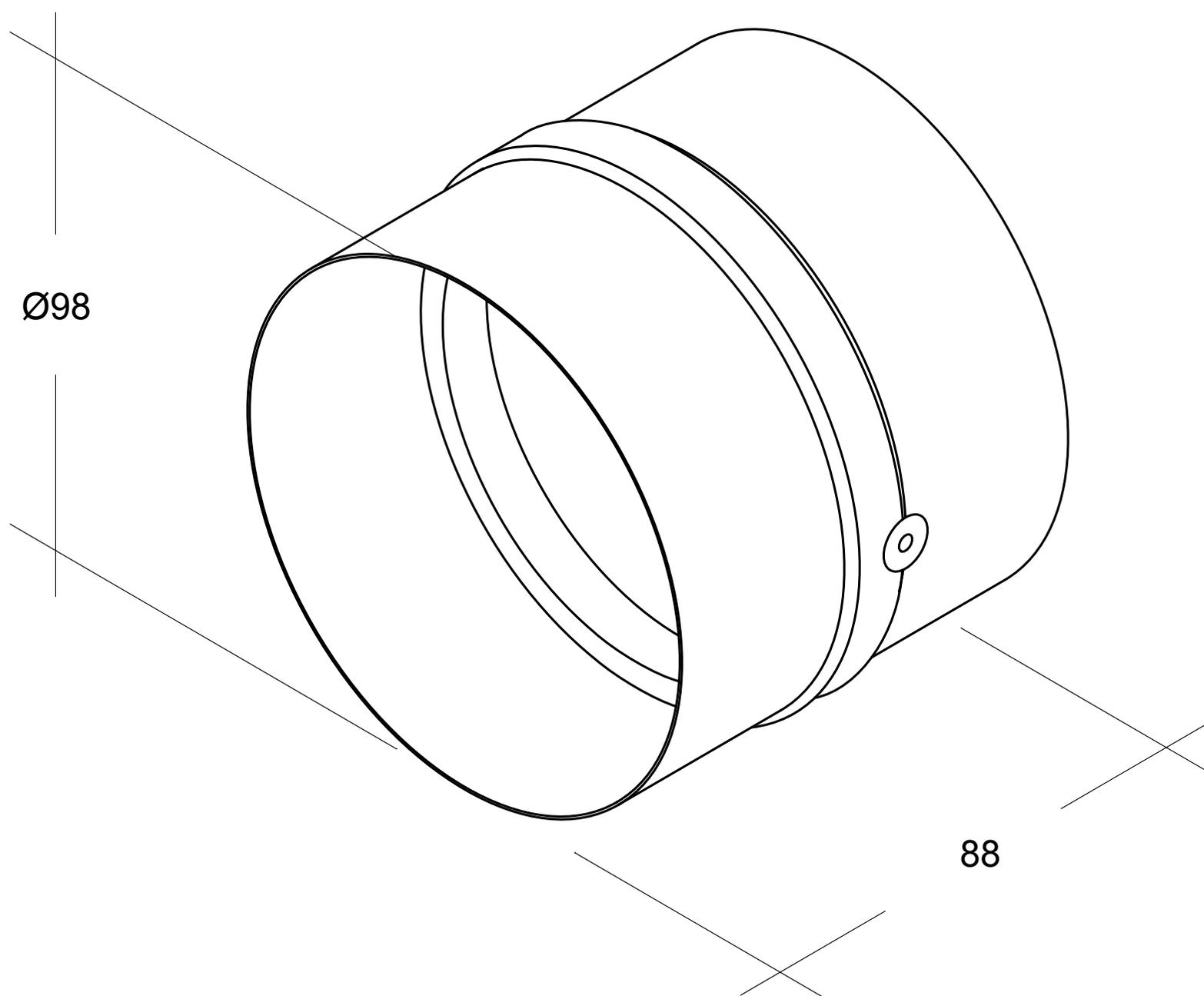
Rückluftsperrklappe NW 100, mit Dichtungsgummi
