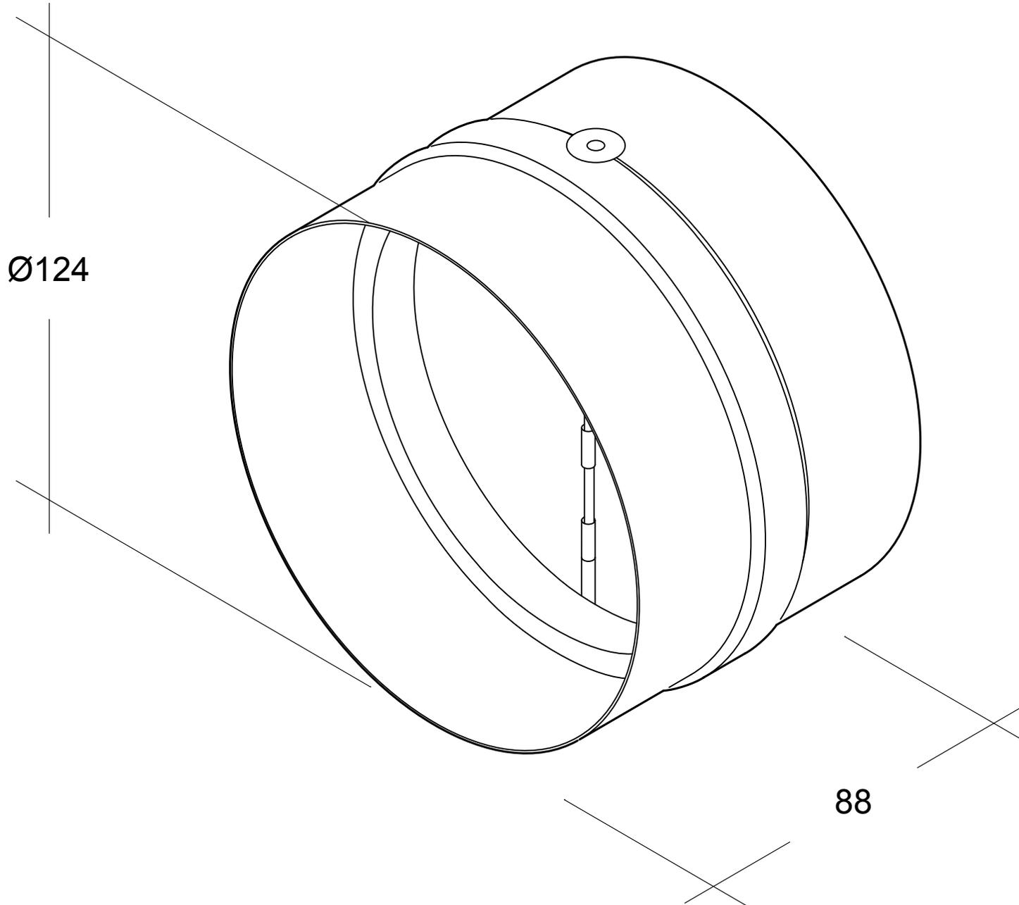
Rückluftsperrklappe NW 125, mit Dichtungsgummi
