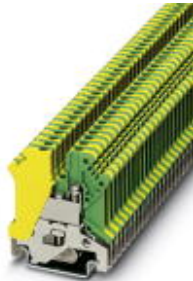
Schutzleiter-Reihenklemme, Anschlussart: Schraubanschluss, Querschnitt: 0,2 mm 2 - 4 mm 2 , AWG: 24 - 12, Breite: 5,2 mm, Farbe: grün-gelb, Montageart: NS 35/7,5, NS 35/15, NS 32
