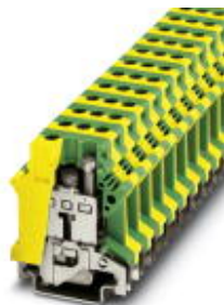
Schutzleiter-Reihenklemme, Anschlussart: Schraubanschluss, Querschnitt: 2,5 mm 2 - 25 mm 2 , AWG: 12 - 4, Breite: 12,2 mm, Höhe: 52,6 mm, Farbe: grün-gelb, Montageart: NS 35/7,5, NS 35/15, NS 32
