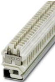
Durchgangsreihenklemme, Anschlussart: Schraubanschluss, Querschnitt: 0,5 mm<sup>2</sup> - 10 mm<sup>2</sup>, AWG 20 - 8, Breite: 8,4 mm, Farbe: weiß, Montageart: NS 3, Isolationsstoff: Keramik
