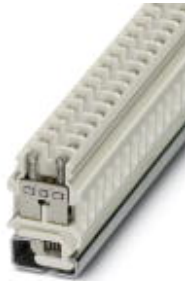
Durchgangsreihenklemme, Anschlussart: Schraubanschluss, Querschnitt: 0,5 mm 2 - 16 mm 2 , AWG 20 - 6, Breite: 10,4 mm, Farbe: weiß, Montageart: NS 3, Isolationsstoff: Keramik
