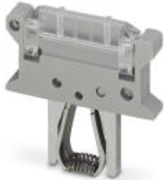
Trennstecker, zur Verwendung der Sicherungs-Grundklemme als Stecker-Trennklemme, Länge: 46 mm, Breite: 7,8 mm, Höhe: 42,7 mm
